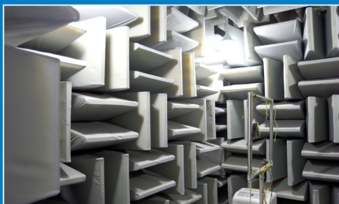
无响室 Anechoic Chamber
